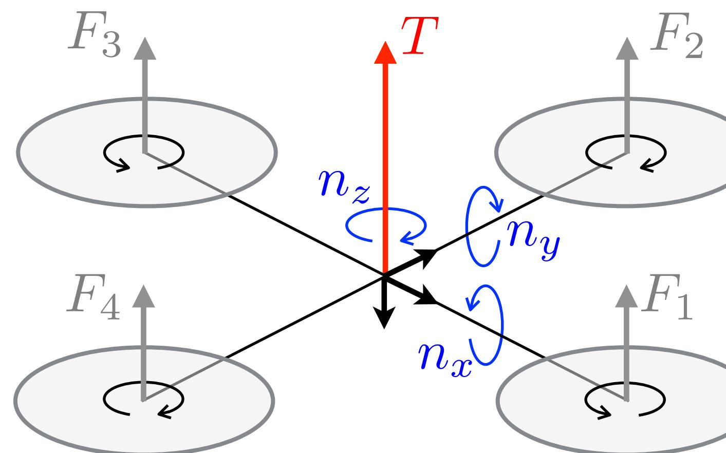
$$\begin{bmatrix} T \\ n_x \\ n_y \\ n_z \end{bmatrix} = \begin{bmatrix} 1 & 1 & 1 & 1 \\ 0 & b & 0 & -b \\ -b & 0 & b & 0 \\ c & -c & c & -c \end{bmatrix} \begin{bmatrix} F_1 \\ F_2 \\ F_3 \\ F_4 \end{bmatrix}$$
